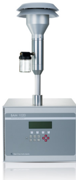
3 pav. Automatinis aplinkos oro teršalų KD 10 ir KD 2,5 analizatorius
